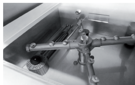
BRAZOS DE LAVADO Mínima incrustación de cal, menor peso, mayor facilidad de giro e inalterable a productos químicos
