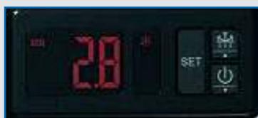
Control de temperatura mediante termostato electrónico digital con lectura constante y posibilidad de desescarche
