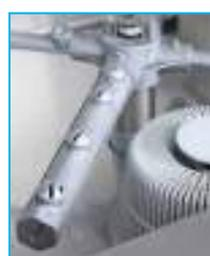
Los **filtros y brazos de lavado** están fabricados en PVC alimentario y fibra de vidrio (30%), de menos peso y fácilmente desmontables, que garantiza la calidad del aclarado desde 2 bares de presión, de fácil acceso y extracción.
