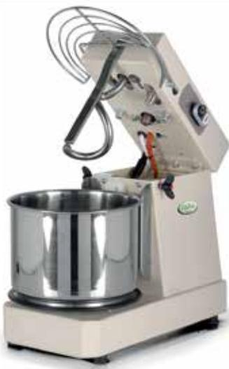
Para uso profesional. Cabezal abatible. Estructura robusta de acero. Motor reductor de alta potencia fabricado en Italia. Transmisión por cadena. Ejes de transmisión de acero. Poleas y coronas de producción nacional. Micro mecánico en la tapa. Cuba, espiral y varilla de acero inoxidable. Fácil de limpiar.
