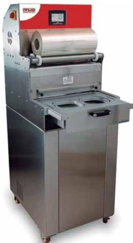
El modelo MVO42 es ideal para producciones medianas en envase SKIN en barqueta, o SKIN UP en "cartoncillo", en productos hasta 3,5 cm de altura. Cambio fácil y rápido de horma (3 minutos). Control electrónico de temperatura, tiempo de sellado, porcentaje de vacío y de gas, así como tiempo extra de vacío... Aviso de final de ciclo. Inserción automática del film. Apertura automática del cajón (opcional) Necesita compresor.
