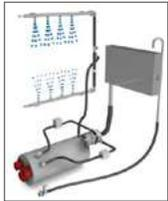
La alimentación mediante sistema con break-tank conforme a las normas WRC; bomba de enjuagado con tecnología de doble envío. El calentamiento se efectúa por medio de una caldera dotada de tres resistencias en aleación Incoloy 800 que alimenta un par de brazos de enjuagado final a través del variador de flujo.
