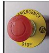
Del tipo de rearme manual, se posicionan en entrada o en salida según la disposición de la zona de lavado.
