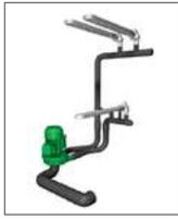
La bomba de doble salida de 1,5 kW tiene un rendimiento equivalente a 1 bomba de 2 kW. Alimenta las 36 boquillas direccionales colocadas en 3 brazos de 40 cm de longitud. El agua sale de las boquillas en forma de lámina estrecha, muy estable y concentrada, ofreciendo resultados óptimos.
