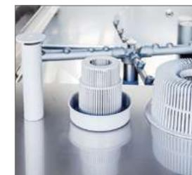
El sistema de **filtrado dFilter** permite una filtración doble y parcial en la superficie externa, para el filtrado de partículas grandes de suciedad, y microfiltración en la superficie interna de pequeñas partículas de suciedad, que garantizan el agua de lavado limpia.
