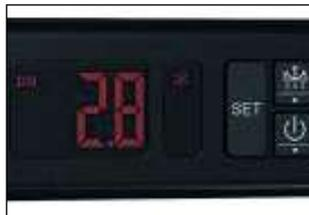
Control de temperatura mediante termostato electrónico digital.
